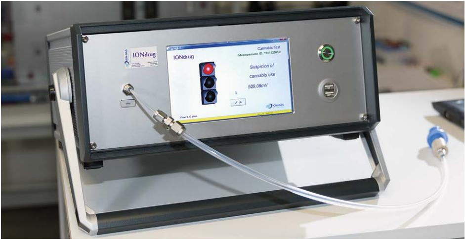
**Abb. 27:** Fotografische Darstellung des mobilen GC-IMS-Demonstrators, wie im Feldexperiment eingesetzt. (ION-GAS GmbH)
