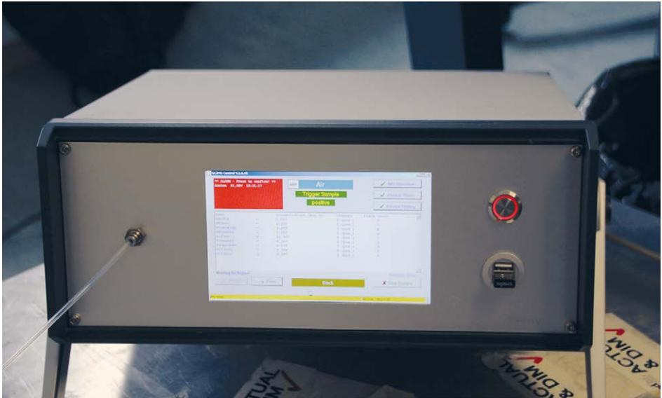
**Abb. 45:** Anzeigemodus des mobilen GC-IMS mit den gemessenen Konzentrationen der in der Datenbank implementierten Substanzliste. (ION-GAS GmbH)
