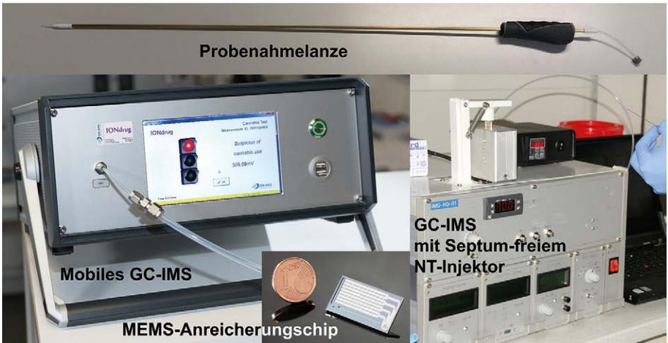
**Abb. Z1:** Mobiles GC-IMS (links) mit Probenahmelanze (oben) wie im Feldexperiment eingesetzt, Anreicherungschip (unten) und Laborgerät mit Septum-freier TD-Einheit für NeedleTraps (rechts). (ION-GAS GmbH).
