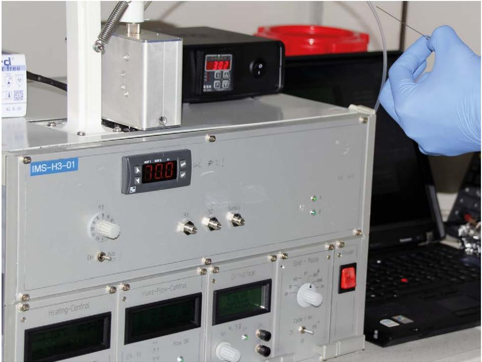
**Abb. 29:** Fotografische Darstellung des Labor-GC-IMS, ausgestattet mit dem eigens für die spezifische Anwendung von NeedleTraps entwickelten Thermodesorptionssystem. (ION-GAS GmbH)
