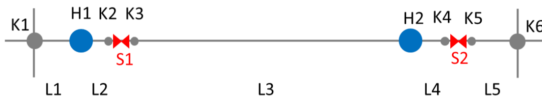
Abbildung 36 Vollständige Modellbildung mit Schiebern und Hydranten als Kanten und Knoten
