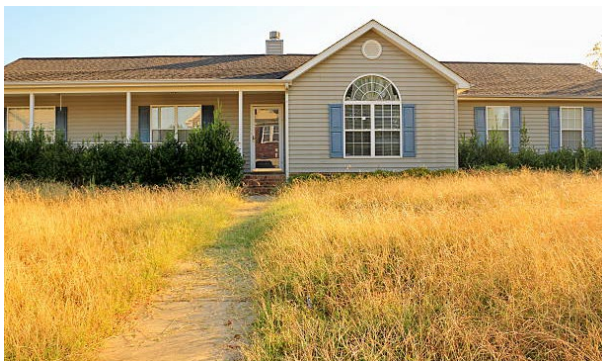
Beispiel für eine zusammenhängende Zone mit natürlichen Brennstoffen im 10-Meter-Radius
