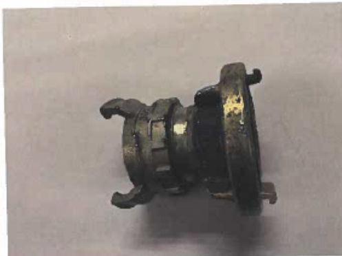
Abbildung 2: Deutsch-französisches Übergangsstück Größe C. (Quelle: Bildrechte bei den Verfassern).
